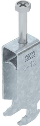
Bügelschelle mit Hammerkopf-Fuß, Metalldruckwanne mit gerundeten Kanten für Kabelschutz. Zur vertikalen und horizontalen Montage von 3 Einzelkabeln an C-Profilsschiene. Für Schlitzweite 16 - 17 mm. Mit 1-gängiger Schraube an Druckwanne, universeller Sechskant-Schraubenkopf SW10, mit Schlitz und Kreuzschlitz. Geeignet für Montage im Innen- und Außenbereich. Mehrere Kabel sollten durch Doppelwannen getrennt werden. Der Einsatz einer Gegenwanne wird empfohlen.
