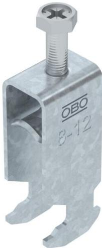
Bügelschelle mit Hammerkopf-Fuß, Metalldruckwanne mit gerundeten Kanten für Kabelschutz. Zur vertikalen und horizontalen Montage von 2 Einzelkabeln an C-Profilsschiene. Für Schlitzweite 16 - 17 mm. Mit 1-gängiger Schraube an Druckwanne, universeller Sechskant-Schraubenkopf SW10, mit Schlitz und Kreuzschlitz. Geeignet für Montage im Innen- und Außenbereich. Mehrere Kabel sollten durch Doppelwannen getrennt werden. Der Einsatz einer Gegenwanne wird empfohlen.
