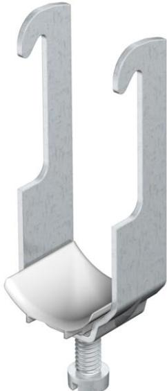
Auch passend zu Winkeleisen mit 40 mm Schenkellänge, Schelle und Schraube aus Aluminium ALMg3, Druckwanne aus Polypropylen, halogenfrei, lichtgrau RAL 7035.
