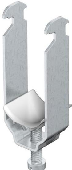
Passend zu allen C-Profilschienen mit 16 - 17 mm Schlitzweite; Schelle und Schraube aus Aluminium ALMg 3, Druckwanne aus Polypropylen, halogenfrei, lichtgrau RAL 7035.
