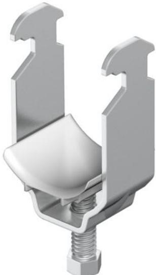
Passend zu allen C-Profilschienen mit 16 - 17 mm Schlitzweite; Schelle und Schraube aus Aluminium ALMg 3, Druckwanne aus Polypropylen, halogenfrei, lichtgrau RAL 7035.
