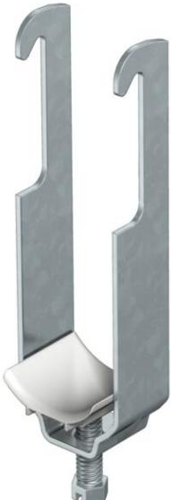
Passend zu Winkeleisen mit 40 mm Schenkellänge. Schelle und Schraube aus tauchfeuerverzinktem Stahl. Druckwanne aus Polypropylen, halogenfrei, Farbe Lichtgrau RAL 7035.
