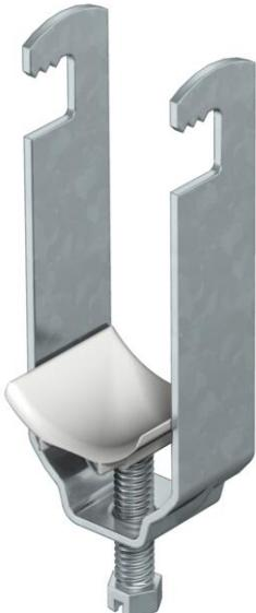
Passend zu Flach-, Winkel- und U-Eisen von 4 - 12 mm Materialstärke. Schelle und Schraube aus tauchfeuerverzinktem Stahl. Druckwanne aus Polypropylen, halogenfrei, Farbe Lichtgrau RAL 7035.
