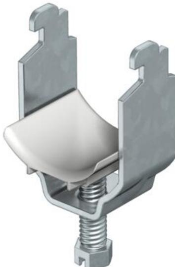
Passend zu allen C-Profilschienen mit 11 - 12 mm Schlitzweite, mindestens 6,5 mm lichter Innenhöhe und mindestens 18,5 mm lichter Innenbreite. Schelle und Schraube aus tauchfeuerverzinktem Stahl. Druckwanne aus Polypropylen, Farbe Lichtgrau RAL 7035, halogenfrei.
