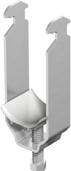
Passend zu allen C-Profilschienen mit 16 - 17 mm Schlitzweite; Schelle und Schraube aus Edelstahl rostfrei, Druckwanne aus Polypropylen, halogenfrei, lichtgrau RAL 7035.
