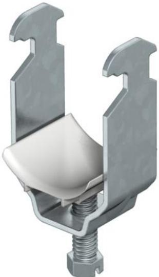
Passend zu allen C-Profilschienen mit 16 - 17 mm Schlitzweite. Schelle und Schraube aus tauchfeuerverzinktem Stahl, Druckwanne aus Polypropylen, halogenfrei, Farbe Lichtgrau RAL 7035.
