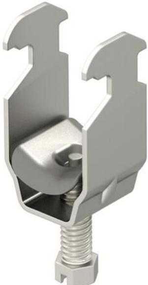
Passend zu allen C-Profilschienen mit 16 - 17 mm Schlitzweite. Schelle, Schraube und Druckwanne aus Stahl rostfreiem Edelstahl.
