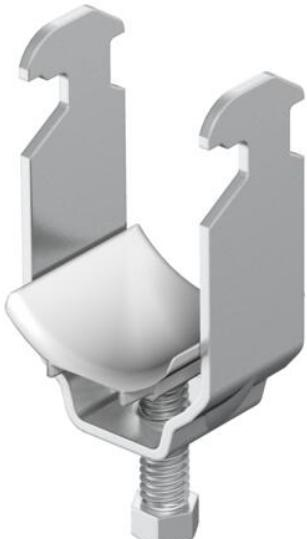
Passend zu allen C-Profilschienen mit 16 - 17 mm Schlitzweite. Schelle und Schraube aus Edelstahl. Druckwanne aus Polypropylen, halogenfrei, Farbe Lichtgrau RAL 7035.
