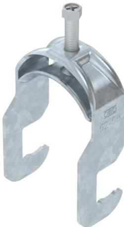
Bügelschelle mit RS-Fuß, Metalldruckwanne mit gerundeten Kanten für Kabelschutz. Zur vertikalen und horizontalen Montage von 1 Einzelkabel an Rundprofilen oder Rohren. Mit 1-gängiger Schraube an Druckwanne, universeller Sechskant-Schraubenzkopf SW10, mit Schlitz und Kreuzschlitz. Passend zu allen Rundprofileisen bzw. Rohren mit Durchmesser bis 22 mm. Geeignet für Montage im Innen- und Außenbereich. Der Einsatz einer Gegenwanne wird empfohlen.
