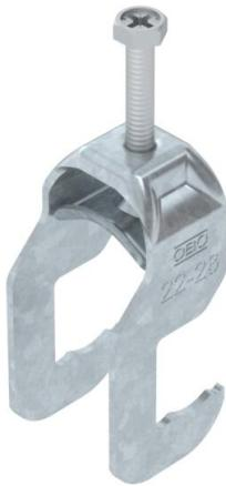
Bügelschelle mit RS-Fuß, Metalldruckwanne mit gerundeten Kanten für Kabelschutz. Zur vertikalen und horizontalen Montage von 1 Einzelkabel an Rundprofilen oder Rohren. Mit 1-gängiger Schraube an Druckwanne, universeller Sechskant-Schraubenzkopf SW10, mit Schlitz und Kreuzschlitz. Passend zu allen Rundprofileisen bzw. Rohren mit Durchmesser bis 22 mm. Geeignet für Montage im Innen- und Außenbereich. Der Einsatz einer Gegenwanne wird empfohlen.
