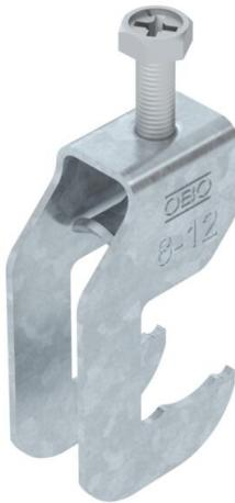
Bügelschelle mit RS-Fuß, Metalldruckwanne mit gerundeten Kanten für Kabelschutz. Zur vertikalen und horizontalen Montage von 1 Einzelkabel an Rundprofilen oder Rohren. Mit 1-gängiger Schraube an Druckwanne, universeller Sechs-kant-Schraubenkopf SW10, mit Schlitz und Kreuzschlitz. Passend zu allen Rundprofileisen bzw. Rohren mit Durchmesser bis 22 mm. Geeignet für Montage im Innen- und Außenbereich. Der Einsatz einer Gegenwanne wird empfohlen.
