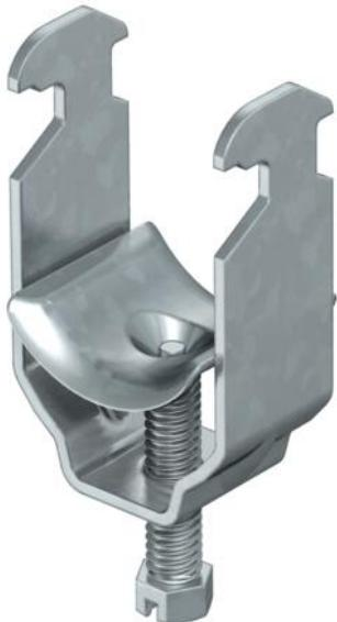
Passend zu allen C-Profilschienen mit 16 - 17 mm Schlitzweite. Schelle, Schraube und Druckwanne aus tauchfeuerverzinktem Stahl.
