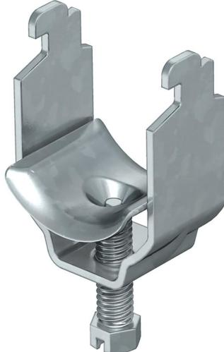
Passend zu allen C-Profilschienen mit 11 - 12 mm Schlitzweite; mindestens 6,5 mm lichter Innenhöhe und mindestens 18,5 mm lichter Innenbreite; Metallwannen haben allseitig stark gerundete Kanten, sodass keine Kabelbeschädigung zu befürchten ist. Ausführung mit Anschweiß- und/oder Kontermutter für Einsatz unter erschwerten Bedingungen sowie für Rüttelsicherheit auf Anfrage!
