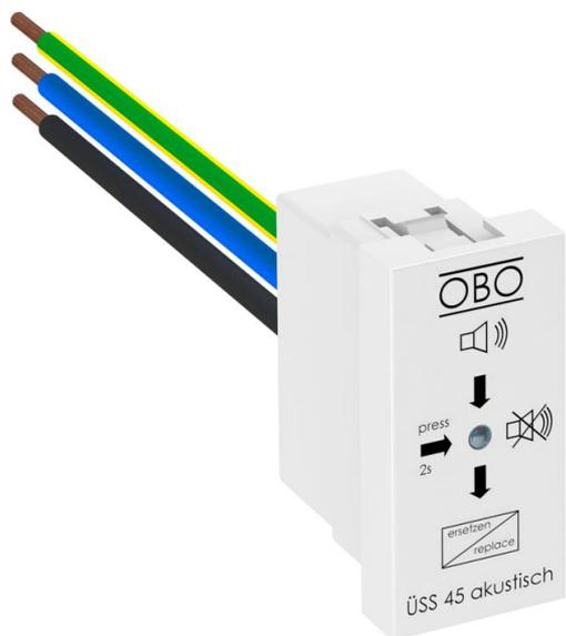
Überspannungsschutz / Netzfeinschutz Typ 3 nach EN 61643-11 zur Installation in Rapid 45-Kanälen, Geräteeinbaukanälen und Unterflur-Systemen.
