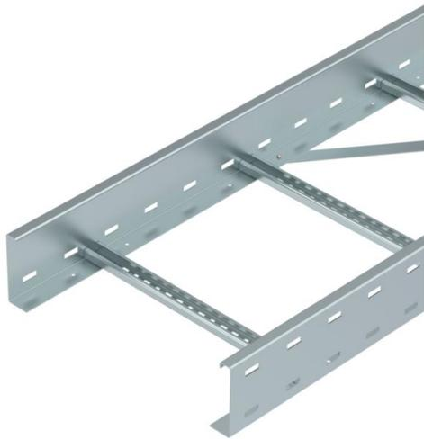
Weitspann-Kabelleiter mit gelochtem Seitenholm in 110 mm Seitenhöhe. Befestigung von Kabeln und Leitungen mit Bügelschelle Typ 2056. Längsverbinder Typ WRVL 110 sind anteilig separat zu bestellen. Magnetische Schirmdämpfung ohne Deckel 10 dB, mit Deckel 15 dB.
