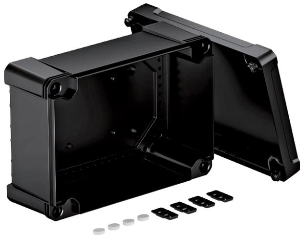
Kabelabzweigkasten zum Verbinden von Kabeln und Leitungen im Innen- und Außenbereich. Rechteckige Form ohne Einführungen. Geeignet für die Wand-/ Deckenmontage mit der Möglichkeit zur Außenbefestigung, Innenbefestigung oder Montage über die Eckdome. Besonders schlagfest mit IK08. Deckel mit Schnellverschluss, plombierbar. Hergestellt aus halogenfreien und UV-beständigen Materialien.
