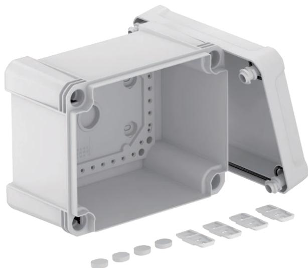
Kabelabzweigkasten zum Verbinden von Kabeln und Leitungen im Innen- und Außenbereich. Rechteckige Form ohne Einführungen. Geeignet für die Wand-/ Deckenmontage mit der Möglichkeit zur Außenbefestigung, Innenbefestigung oder Montage über die Eckdome. Besonders schlagfest mit IK09. Deckel mit Schnellverschluss, plombierbar. Hergestellt aus halogenfreien und UV-beständigen Materialien.
