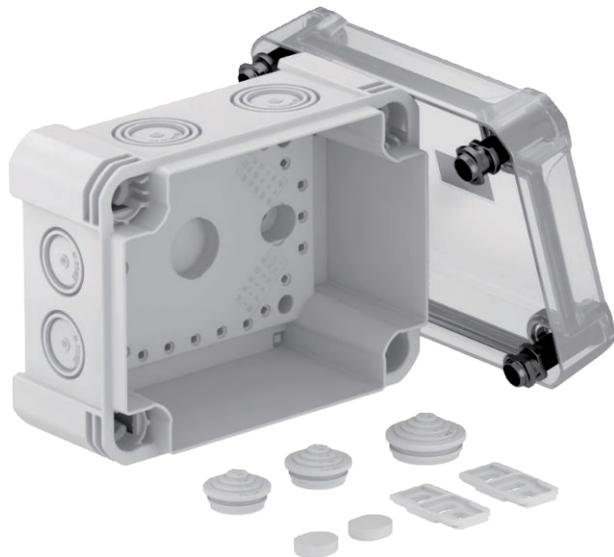
Kabelabzweigkasten zum Verbinden von Kabeln und Leitungen im Innen- und Außenbereich. Rechteckige Form mit Ausschlageinführungen. Geeignet für die Wand-/ Deckenmontage mit der Möglichkeit zur Außenbefestigung, Innenbefestigung oder Montage über die Eckdome. Besonders schlagfest mit IK09. Transparenter Deckel mit Schnellverschluss, plombierbar. Hergestellt aus halogenfreien und UV-beständigen Materialien.
