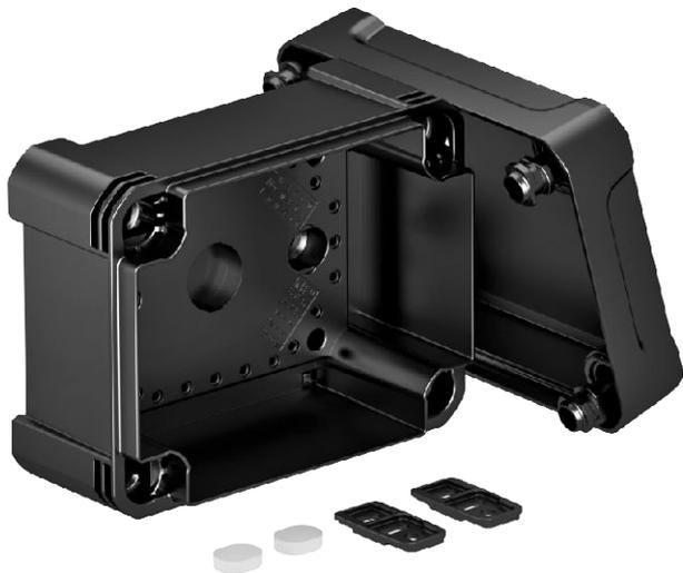
Kabelabzweigkasten zum Verbinden von Kabeln und Leitungen im Innen- und Außenbereich. Rechteckige Form ohne Einführungen. Geeignet für die Wand-/ Deckenmontage mit der Möglichkeit zur Außenbefestigung, Innenbefestigung oder Montage über die Eckdome. Besonders schlagfest mit IK08. Deckel mit Schnellverschluss, plombierbar. Hergestellt aus halogenfreien und UV-beständigen Materialien.
