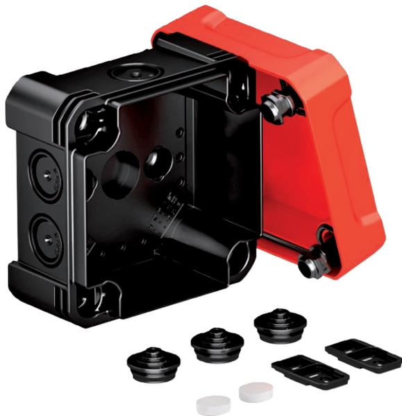
Kabelabzweigkasten zum Verbinden von Kabeln und Leitungen im Innen- und Außenbereich. Quadratische Form mit Ausschlageinführungen. Geeignet für die Wand-/ Deckenmontage mit der Möglichkeit zur Außenbefestigung, Innenbefestigung oder Montage über die Eckdome. Besonders schlagfest mit IK09. Deckel mit Schnellverschluss, plombierbar. Hergestellt aus halogenfreien und UV-beständigen Materialien.
