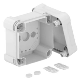
Kabelabzweigkasten zum Verbinden von Kabeln und Leitungen im Innen- und Außenbereich. Quadratische Form ohne Einführungen. Geeignet für die Wand-/ Deckenmontage mit der Möglichkeit zur Außenbefestigung, Innenbefestigung oder Montage über die Eckdome. Besonders schlagfest mit IK08. Deckel mit Schnellverschluss, plombierbar. Hergestellt aus halogenfreien und UV-beständigen Materialien.
