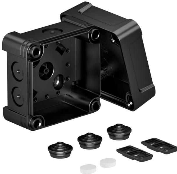
Kabelabzweigkasten zum Verbinden von Kabeln und Leitungen im Innen- und Außenbereich. Quadratische Form mit Ausschlageinführungen. Geeignet für die Wand-/ Deckenmontage mit der Möglichkeit zur Außenbefestigung, Innenbefestigung oder Montage über die Eckdome. Besonders schlagfest mit IK09. Deckel mit Schnellverschluss, plombierbar. Hergestellt aus halogenfreien und UV-beständigen Materialien.
