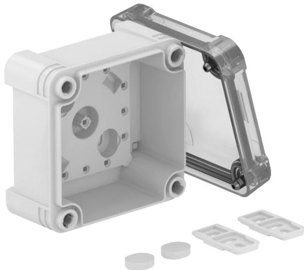
Kabelabzweigkasten zum Verbinden von Kabeln und Leitungen im Innen- und Außenbereich. Quadratische Form ohne Einführungen. Geeignet für die Wand-/ Deckenmontage mit der Möglichkeit zur Außenbefestigung, Innenbefestigung oder Montage über die Eckdome. Besonders schlagfest mit IK08. Transparenter Deckel mit Schnellverschluss, plombierbar. Hergestellt aus halogenfreien und UV-beständigen Materialien.
