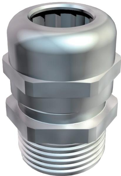
Robuste Kabelverschraubung mit metrischem Anschlussgewinde nach IEC 423 in Hutmutterbauart für hohe Dichtigkeitsansprüche. Zugentlastung, Verdreherschutz und Dichtigkeit über den gesamten Spannungsbereich. Für dickere Gehäusewandstärken in Verbindung mit Gegenmutter. Dichtring aus Neopren. Klemmeinsatz aus Polyamid. Mit vormontiertem Dichtring am Anschlussgewinde, VDE-geprüft nach DIN EN 50262, Schutzart IP68 bei 5 bar/1 h. Mit langem Anschlussgewinde.
