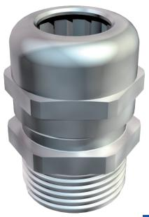
Robuste Kabelverschraubung mit metrischem Anschlussgewinde nach IEC 423 in Hutmutterbauart für hohe Dichtigkeitsansprüche. Zugentlastung, Verdrehschutz und Dichtigkeit über den gesamten Spannbereich. Für dickere Gehäusewandstärken in Verbindung mit Gegenmutter. Dichtring aus Neopren. Klemmeinsatz aus Polyamid. Mit vormontiertem Dichtring am Anschlussgewinde, VDE-geprüft nach DIN EN 50262, Schutzart IP68 bei 5 bar/1 h. Mit langem Anschlussgewinde.
