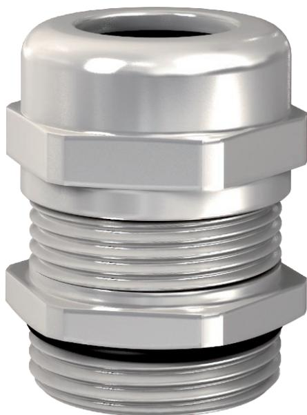
Robuste EMV Kabelverschraubung mit metrischem Anschlussgewinde nach IEC 423 in Hutmutterbauart für hohe Dichtigkeitsansprüche. Die Kontaktierung zwischen Verschraubung und Schirmgeflecht erfolgt über eine Kontaktfeder. Zugentlastung, Verdreherschutz und Dichtigkeit über den gesamten Spannungsbereich. Dichtring aus Neopren. Klemmeinsatz aus Polyamid. Mit vormontiertem O-Dichtring am Anschlussgewinde, VDE-geprüft nach DIN EN 50262, Schutzart IP68 bei 5 bar/1 h.
