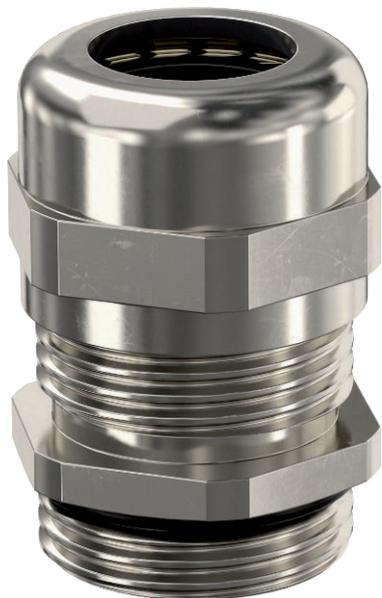
Robuste Kabelverschraubung mit metrischem Anschlussgewinde nach IEC 423 in Hutmutterbauart für hohe Dichtigkeitsansprüche. Zugentlastung, Verdrehenschutz und Dichtigkeit über den gesamten Spannungsbereich. Dichtring aus Neopren. Klemmeinsatz aus Polyamid. Mit vormontiertem Dichtring am Anschlussgewinde, VDE-geprüft nach DIN EN 50262, Schutzart IP68 bei 5 bar/1h, Temperatureinsatzbereich -20 - 100°C.
