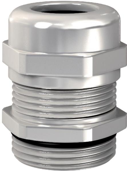
Robuste EMV Kabelverschraubung mit metrischem Anschlussgewinde nach IEC 423 in Hutmutterbauart für hohe Dichtigkeitsansprüche. Die Kontaktierung zwischen Verschraubung und Schirmgeflecht erfolgt über eine Kontaktfeder. Zugentlastung, Verdrehenschutz und Dichtigkeit über den gesamten Spannungsbereich. Dichtring aus Neopren. Klemmeinsatz aus Polyamid. Mit vormontiertem O-Dichtring am Anschlussgewinde, VDE-geprüft nach DIN EN 50262, Schutzart IP68 bei 5 bar/1 h.
