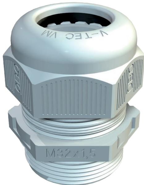
Die schnellste und bequemste Art mit Kabelverschraubungen an Kabelabzweigkästen und Gehäusen für Zugentlastung und Dichtigkeit zu sorgen: die bewährte V-TEC VM Kabelverschraubungen von OBO. Mit der integrierten Dichtlippe und speziellen OBO Lamellentechnik wird die Schutzklasse IP68 erreicht. Zugentlastung und Dichtigkeit sind geprüft nach DIN EN 62444.
