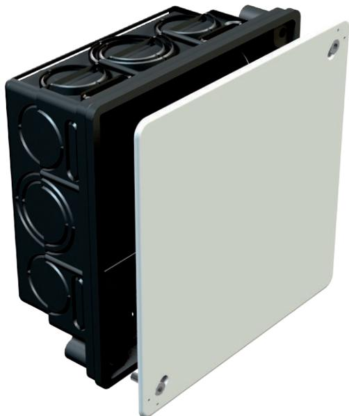
Verbindungskasten für das Verkleben von Klemmen, mit Deckel und Deckelschraube (15 mm), Deckelrand liegt plan auf, Oberfläche ist aufgeraut, in Verbindung mit Deckel und Deckelschrauben erreichen die Verbindungsstellen das VDE-Prüfzeichen nach VDE 0606 und werden flammwidrig nach VDE 0471/DIN 695 Teil 2-1, Prüftemperatur 750 °C, Schutzart IP20.
