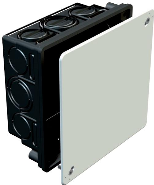
Verbindungskasten für das Verkleben von Klemmen, mit Deckel und Deckelschraube (15 mm), Deckelrand liegt plan auf, Oberfläche ist aufgeraut, in Verbindung mit Deckel und Deckelschrauben erreichen die Verbindungsstellen das VDE-Prüfzeichen nach VDE 0606 und werden flammwidrig nach VDE 0471/DIN 695 Teil 2-1, Prüftemperatur 750 °C, Schutzart IP20.
