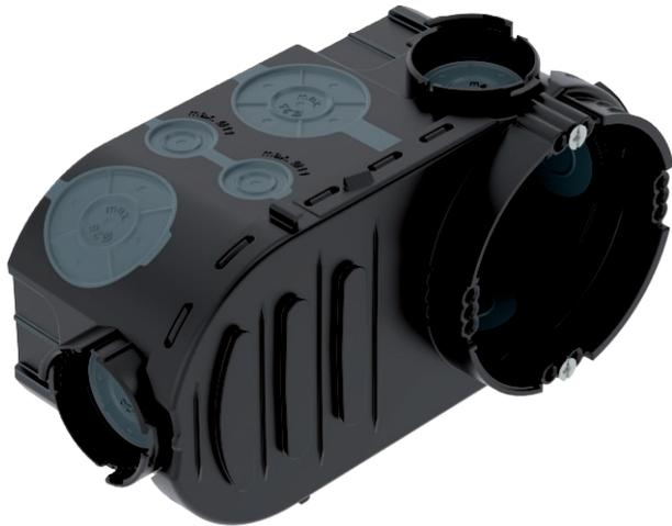
Unterputz-Elektronikdose mit zusätzlichem Klemmraum und luftdichten Membraneinführungen, für den Einsatz in Mauerwerk mit einer Einbautiefe von mindestens 67 mm.
