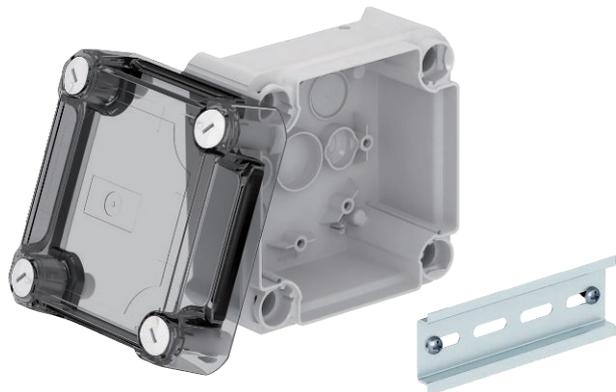
Kabelabzweigkasten geschlossen zum Verbinden von Kabeln und Leitungen im Innenbereich und geschützten Außenbereichen. Quadratische Form ohne Einführungen. Geeignet für die Wand-/Deckenmontage und die Montage auf Montageblechen. Mit der Möglichkeit zur Innenbefestigung und Montage über die Eckdome. Hoher, transparenter Deckel mit Schnellverschluss, plombierbar. Hergestellt aus halogenfreien Materialien.
