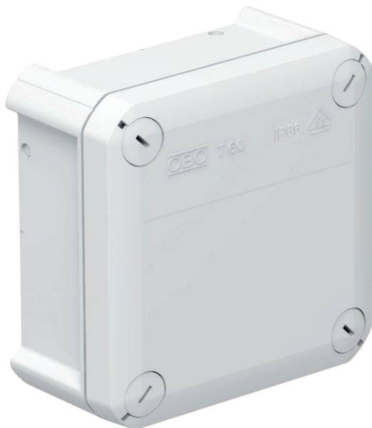
Kabelabzweigkasten zum Verbinden von Kabeln und Leitungen im Innenbereich und geschützten Außenbereichen. Quadratische Form ohne Einführungen. Geeignet für die Wand-/ Deckenmontage und die Montage auf Montageblechen. Mit der Möglichkeit zur Innenbefestigung und Montage über die Eckdome. Deckel mit Schnellverschluss, plombierbar. Hergestellt aus halogenfreien Materialien.
