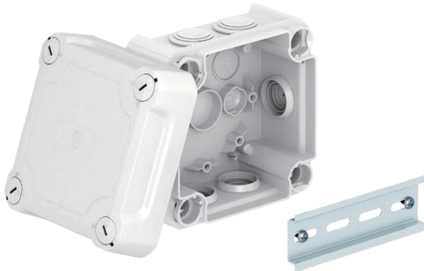
Kabelabzweigkasten zum Verbinden von Kabeln und Leitungen im Innenbereich und geschützten Außenbereichen. Quadratische Form mit Einsteckdichtungen an den Seiten und Ausschlageneinführungen im Boden. Geeignet für die Wand-/ Deckenmontage und die Montage auf Montageblechen. Mit der Möglichkeit zur Innenbefestigung und Montage über die Eckdome. Hoher Deckel mit Schnellverschluss, plombierbar. Hergestellt aus halogenfreien Materialien. Inklusive Hutprofilschiene.
