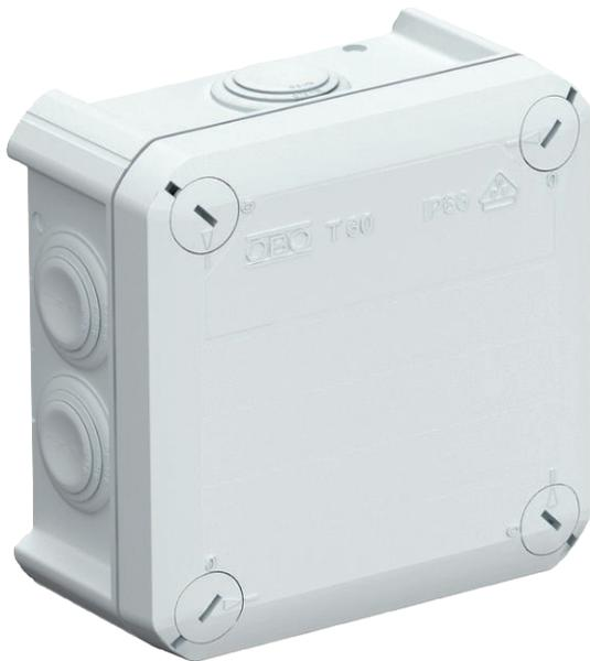
Kabelabzweigkasten zum Verbinden von Kabeln und Leitungen im Innenbereich und geschützten Außenbereichen. Quadratische Form mit Einsteckdichtungen an den Seiten und Ausschlageinführungen im Boden. Geeignet für die Wand-/ Deckenmontage und die Montage auf Montageblechen. Mit der Möglichkeit zur Innenbefestigung und Montage über die Eckdome. Deckel mit Schnellverschluss, plombierbar. Hergestellt aus halogenfreien Materialien. Flammwidrige Ausführung aus speziellem Polypropylen.
