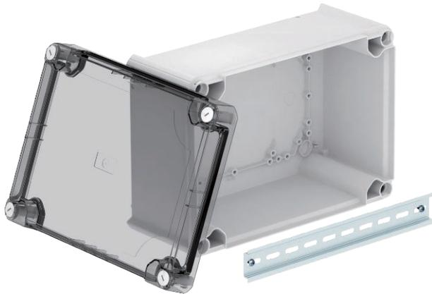
Kabelabzweigkasten geschlossen zum Verbinden von Kabeln und Leitungen im Innenbereich und geschützten Außenbereichen. Rechteckige Form ohne Einführungen. Geeignet für die Wand-/Deckenmontage, die Montage auf Montageblechen und Gewinde im Boden. Mit der Möglichkeit zur Innenbefestigung und Montage über die Eckdome. Hoher, transparenter Deckel mit Schnellverschluss, plombierbar. Hergestellt aus halogenfreien Materialien. Inklusive Hutprofilschiene.
