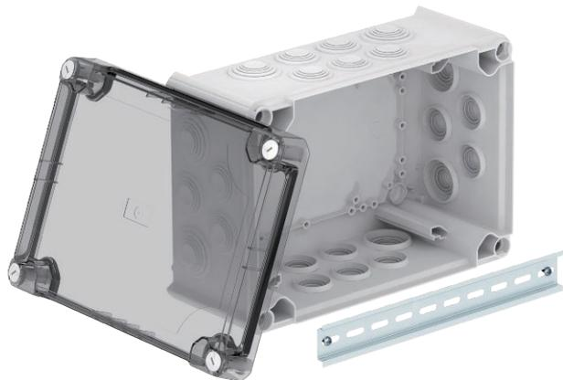
Kabelabzweigkasten zum Verbinden von Kabeln und Leitungen im Innenbereich und geschützten Außenbereichen. Rechteckige Form mit Einsteckdichtungen. Geeignet für die Wand-/Deckenmontage, die Montage auf Montageblechen und Gewinde im Boden. Mit der Möglichkeit zur Innenbefestigung und Montage über die Eckdome. Hoher, transparenter Deckel mit Schnellverschluss, plombierbar. Hergestellt aus halogenfreien und UV-stabilisierten Materialien. Inklusive Hutprofilschiene.
