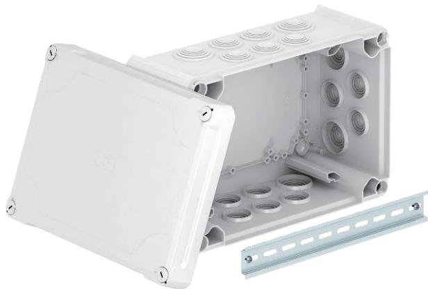
Kabelabzweigkasten zum Verbinden von Kabeln und Leitungen im Innenbereich und geschützten Außenbereichen. Rechteckige Form mit Einsteckdichtungen. Geeignet für die Wand-/Deckenmontage, die Montage auf Montageblechen und Gewinde im Boden. Mit der Möglichkeit zur Innenbefestigung und Montage über die Eckdome. Hoher Deckel mit Schnellverschluss, plombierbar. Hergestellt aus halogenfreien Materialien.
