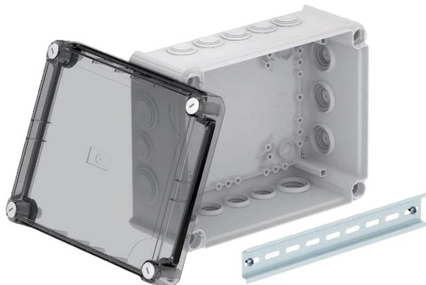
Kabelabzweigkasten zum Verbinden von Kabeln und Leitungen im Innenbereich und geschützten Außenbereichen. Rechteckige Form mit Einsteckdichtungen an den Seiten und Ausschlageinführungen im Boden. Geeignet für die Wand-/ Deckenmontage, die Montage auf Montageblechen und Gewinde im Boden. Mit der Möglichkeit zur Innenbefestigung und Montage über die Eckdome. Hoher, transparenter Deckel mit Schnellverschluss, plombierbar. Hergestellt aus halogenfreien Materialien.
