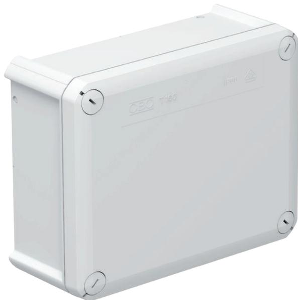
Kabelabzweigkasten zum Verbinden von Kabeln und Leitungen im Innenbereich und geschützten Außenbereichen. Rechteckige Form ohne Einführungen. Geeignet für die Wand-/ Deckenmontage und die Montage auf Montageblechen Mit der Möglichkeit zur Innenbefestigung und Montage über die Eckdome. Deckel mit Schnellverschluss, plombierbar. Hergestellt aus halogenfreien Materialien.
