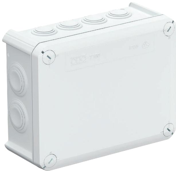
Kabelabzweigkasten zum Verbinden von Kabeln und Leitungen im Innenbereich und geschützten Außenbereichen. Rechteckige Form mit Einsteckdichtungen an den Seiten und Ausschlageneinführungen im Boden. Geeignet für die Wand-/ Deckenmontage und die Montage auf Montageblechen. Mit der Möglichkeit zur Innenbefestigung und Montage über die Eckdome. Deckel mit Schnellverschluss, plombierbar. Flammwidrige Ausführung aus speziellem Polypropylen.
