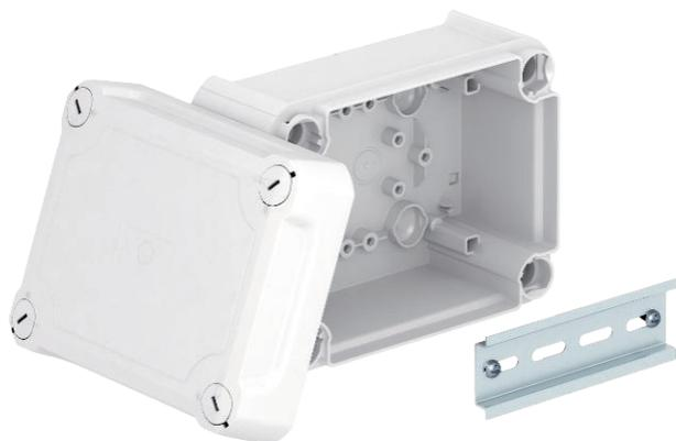
Kabelabzweigkasten geschlossen zum Verbinden von Kabeln und Leitungen im Innenbereich und geschützten Außenbereichen. Rechteckige Form ohne Einführungen. Geeignet für die Wand-/Deckenmontage und die Montage auf Montageblechen. Mit der Möglichkeit zur Innenbefestigung und Montage über die Eckdome. Hoher Deckel mit Schnellverschluss, plombierbar. Hergestellt aus halogenfreien Materialien.
