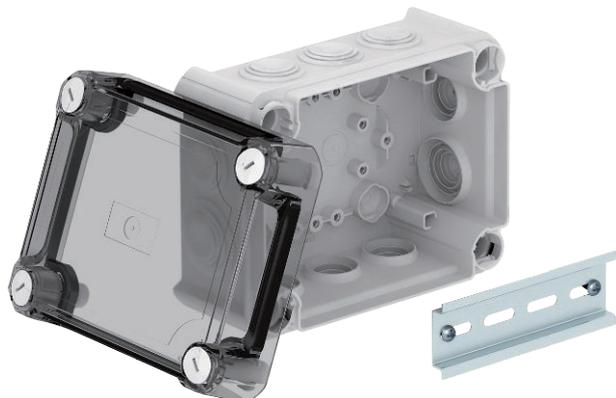
Kabelabzweigkasten zum Verbinden von Kabeln und Leitungen im Innenbereich und geschützten Außenbereichen. Rechteckige Form mit Einsteckdichtungen an den Seiten und Ausschlageneinführungen im Boden. Geeignet für die Wand-/ Deckenmontage und die Montage auf Montageblechen. Mit der Möglichkeit zur Innenbefestigung und Montage über die Eckdome. Hoher, transparenter Deckel mit Schnellverschluss, plombierbar. Hergestellt aus halogenfreien Materialien.
