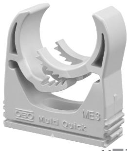
Aufputzschelle zur Aufnahme von metrischen Rohren sowie Elektroinstallationsrohr Quick-Pipe. Flexibler Spannbereich von mehreren Millimetern. Universelle Befestigungsmöglichkeiten an Wand und Decke im Innen- und Außenbereich. Werkzeuglose Rohrmontage. Aneinander reihbar auch mit OBO Quick- oder starQuick-Schelle.
