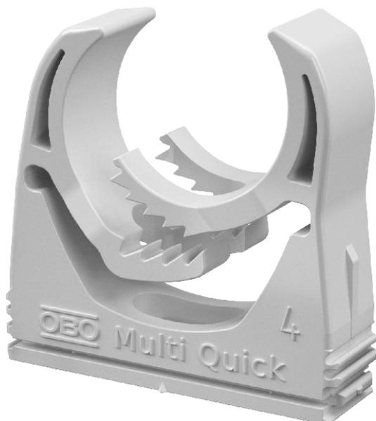
Aufputzschelle zur Aufnahme von metrischen und PG-Rohren sowie Elektroinstallationsrohr Quick-Pipe. Flexibler Spannungsbereich von mehreren Millimetern. Universelle Befestigungsmöglichkeiten an Wand und Decke und einsetzbar in Profilschiene im Innen- und geschützten Außenbereich. Werkzeuglose Rohrmontage. Aneinander reihbar auch mit OBO Quick- oder starQuick-Schelle.
